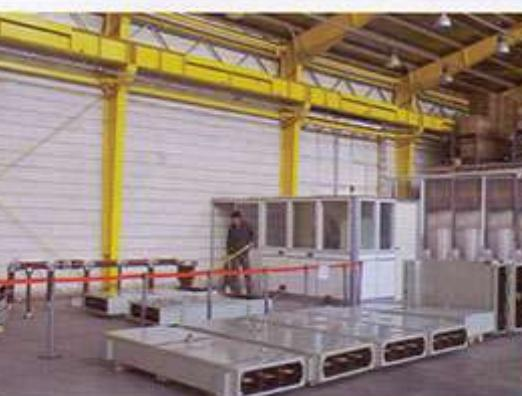
تولید و تست با سداکتهای MV مدل MEB
